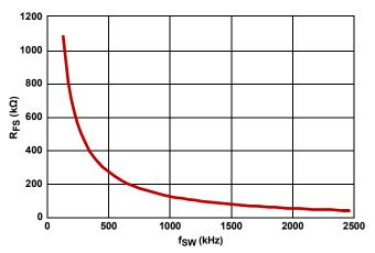
FIGURE 33. R<sub>FS</sub> vs FREQUENCY
