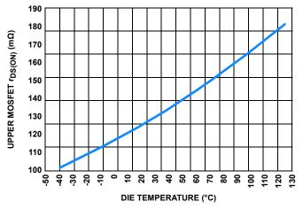
FIGURE 17. UPPER MOSFET  $r_{\text{DS(ON)}} \, (\text{m}\Omega)$  over-temperature
