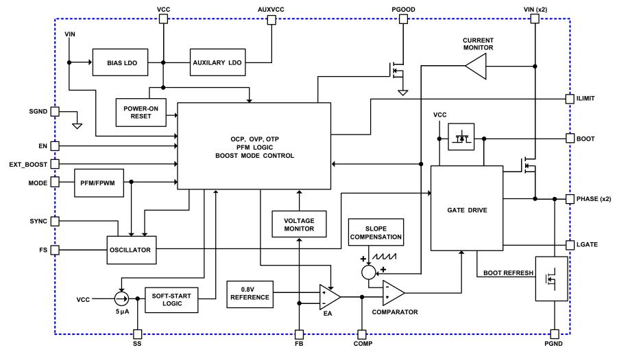
FIGURE 3. BLOCK DIAGRAM
