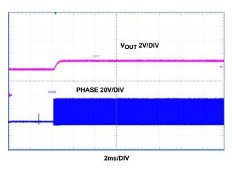
FIGURE 20. V<sub>IN</sub> 36V, PREBIASED START-UP
