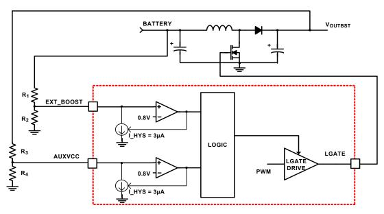
FIGURE 32. BOOST CONVERTER CONTROL
