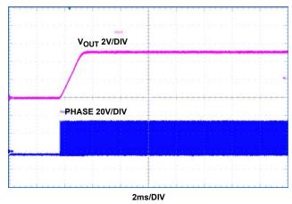
FIGURE 18. SYNCHRONOUS BUCK MODE,  $V_{\mbox{\footnotesize{IN}}}$  36V,  $I_{\mbox{\footnotesize{O}}}$  2A, ENABLE ON
