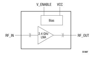
Figure 1. SKY65405-21 LNA Block Diagram
