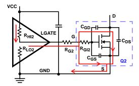
FIGURE 4. TYPICAL LOWER-GATE DRIVE TURN-ON PATH
