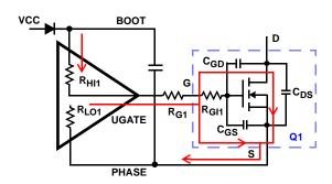
FIGURE 3. TYPICAL UPPER-GATE DRIVE TURN-ON PATH
